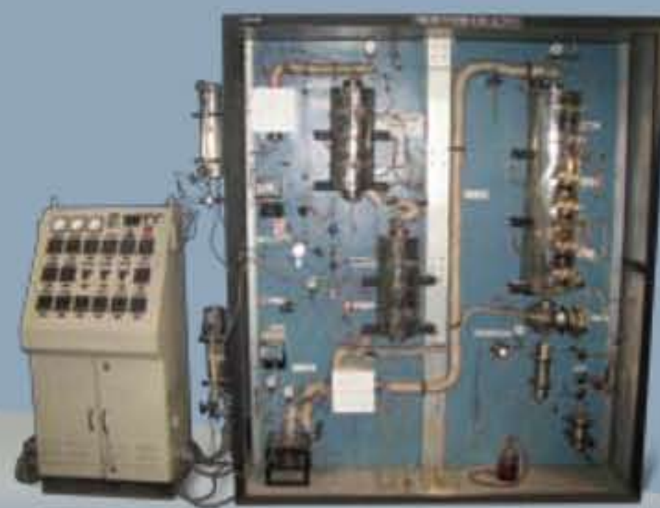
Prereformer Mini Plant
